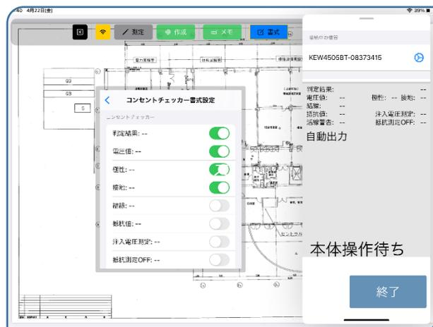
測定値が反映されると書式設定で選択した項目の測定値のみが表示されます。測定値を反映後、測定ポイントを選択した状態でコンセントチェッカーの書式設定を表示し、設定項目を変更すると測定ポイントの表示項目が変わります。
