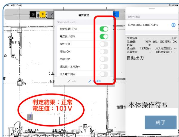
測定ポイントは複数選択することができ、複数の測定ポイントを選択した状態で表示項目を変更した場合、選択したすべての測定ポイントの表示項目が変更されます。測定ポイントを選択せずに表示項目を変更した場合、今後新たに作成する測定ポイントの表示項目が変更されます。
